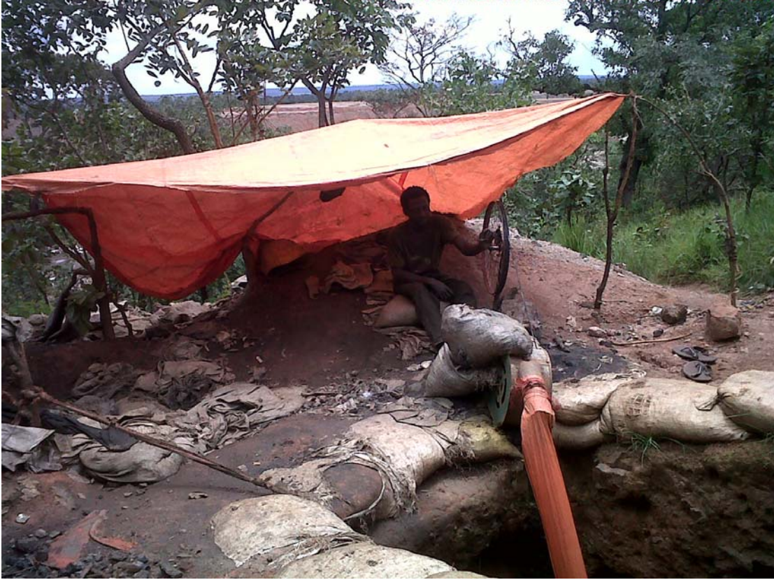
Système de ventilation improvisé pour un puits de mine du site de Tilwezembe, près de Kolwezi, février 2012. © Action contre l'impunité pour les droits humains (ACIDH)
